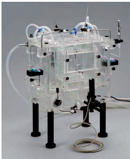
■ Mini Langendorff, amely izolált szívpreparátum vizsgálatára alkalmas (Experimetria Kft.-vel közös fejlesztés)
