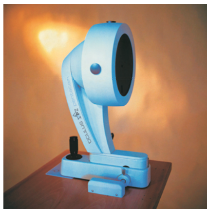
5. ábra. A Pentacam készülék képe: cornea vastagság mérés, a cornea szerkezetének analizálását, topográfiát, elülső csarnok anatómiai elemzését, szemlencse denzitometriát végez. (A felvétel 2 másodperc alatt készül el)
