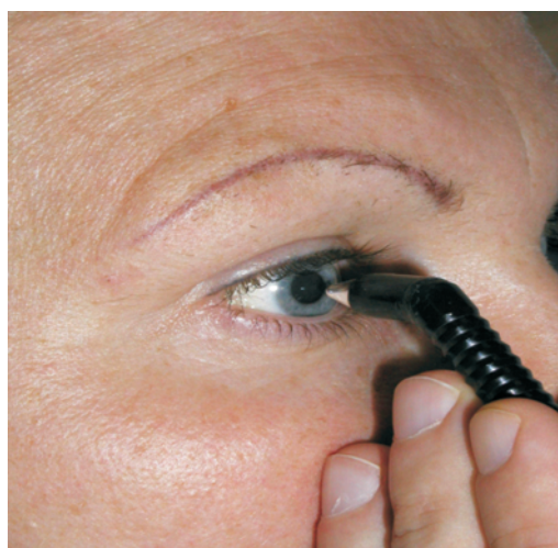
13. ábra. Az ultraszagos pachymeter képe. Mérésnél az ultraszagos transzducert az előzetesen érzéstelenített szaruhártya síkjára mérőlegesen kell tartani.
