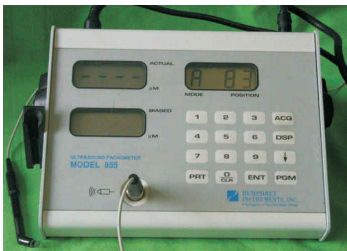
13. ábra. Az ultraszagos pachymeter képe. Mérésnél az ultraszagos transzducert az előzetesen érzéstelenített szaruhártya síkjára mérőlegesen kell tartani.
